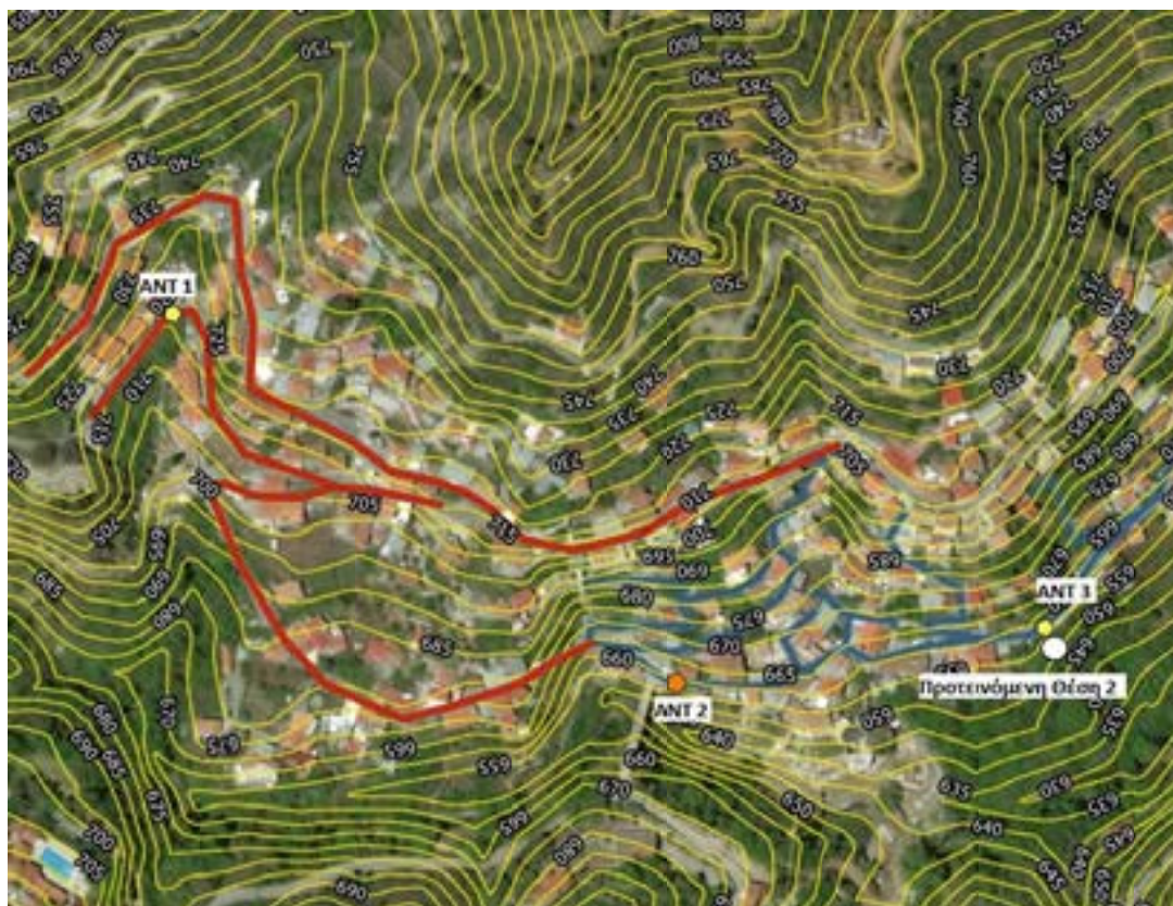
Εικόνα 185: Ελάχιστα απαιτούμενα αντλιοστάσια για μεταφορά στη θέση 2
