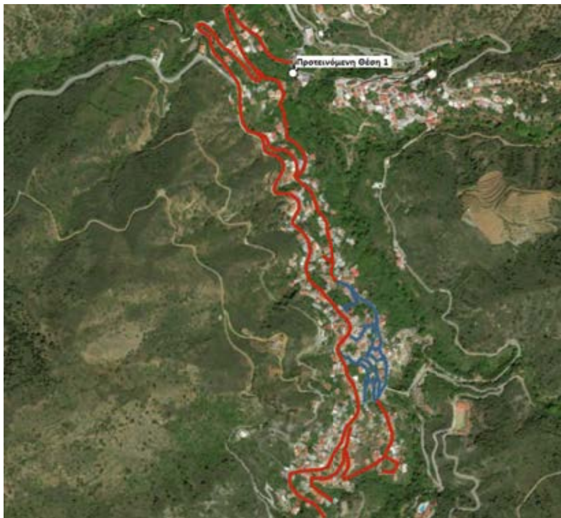
Εικόνα 177: Προτεινόμενο Αποχετευτικό Δίκτυο Καλοπαναγιώτη
