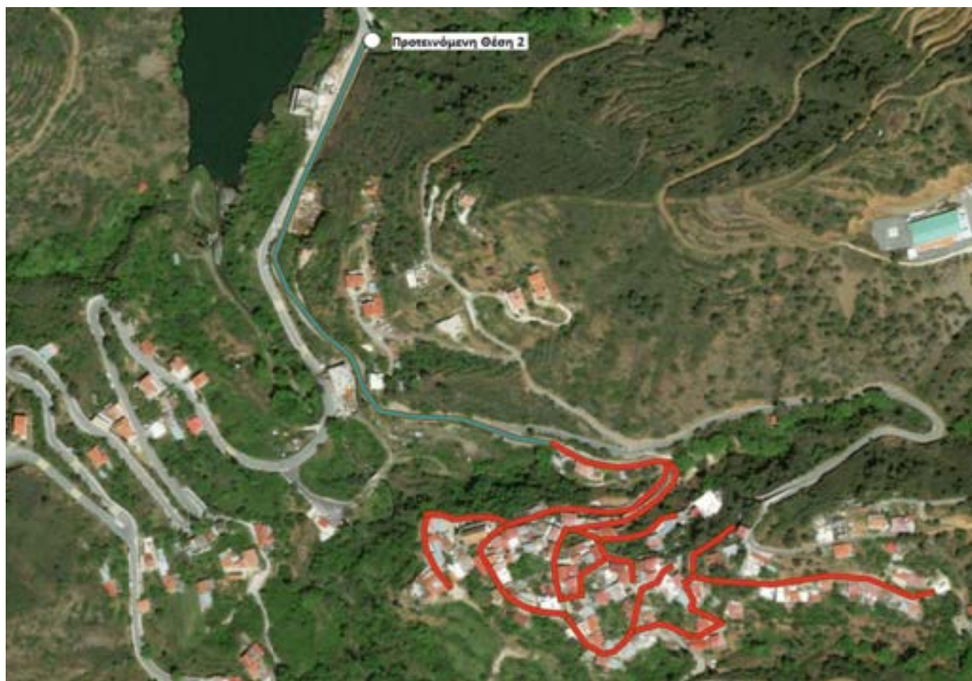
Εικόνα 165: Προτεινόμενο Αποχετευτικό Δίκτυο Οίκου – Εναλλακτική 2 η
