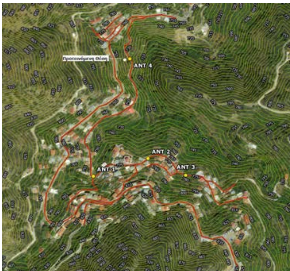
Εικόνα 155: Ελάχιστα απαιτούμενα αντλιοστάσια
