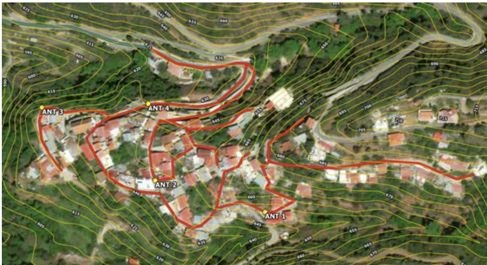
Εικόνα 168: Ελάχιστα απαιτούμενα αντλιοστάσια
