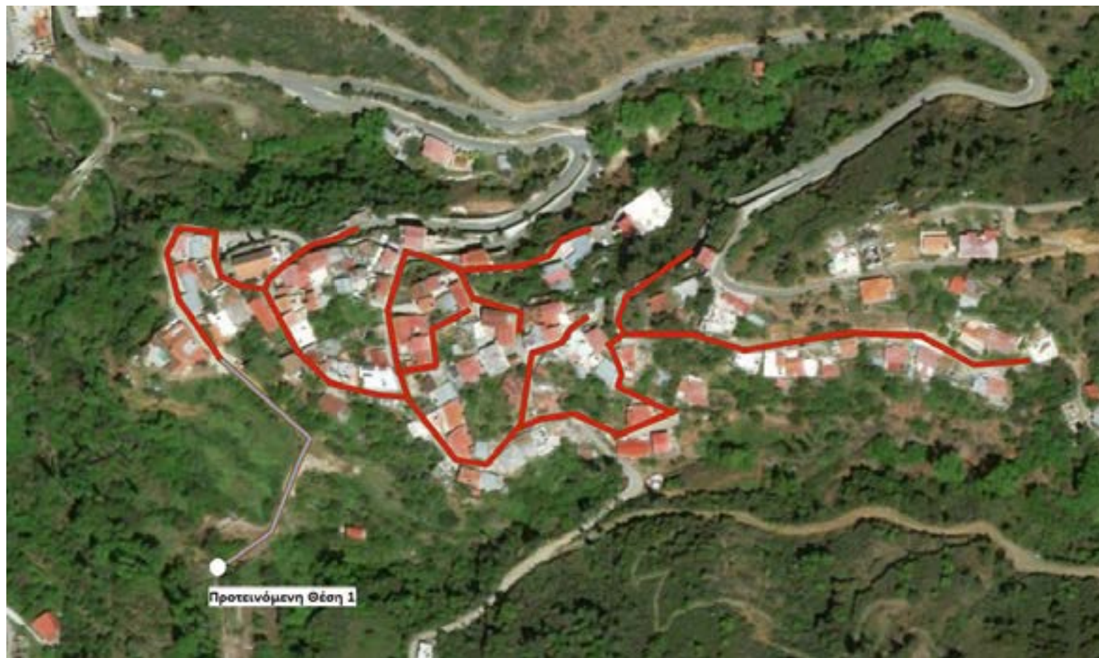
Εικόνα 162: Προτεινόμενο Αποχετευτικό Δίκτυο Οίκου – Εναλλακτική 1 η
