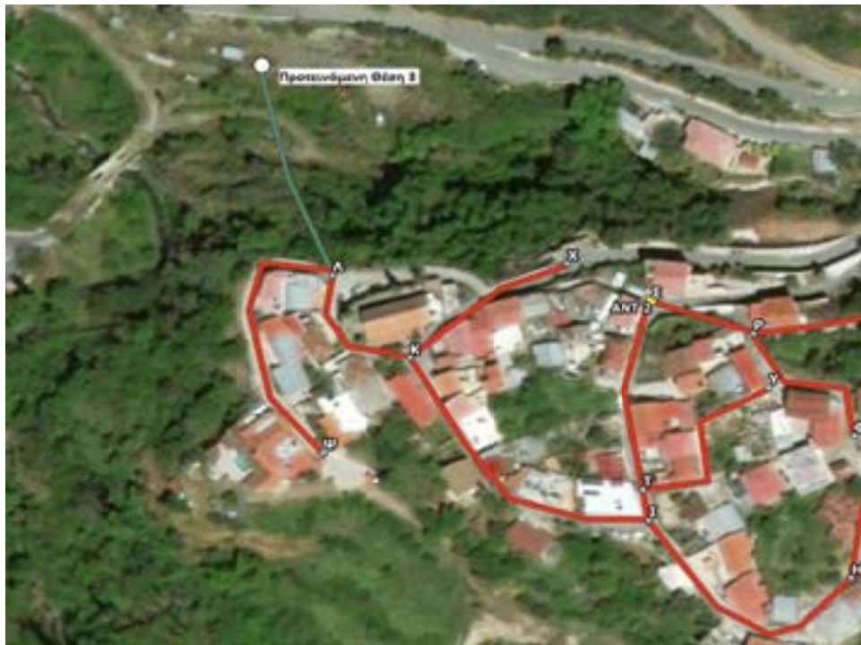
Εικόνα 171: Αγωγός προσαγωγής προς θέση 3
