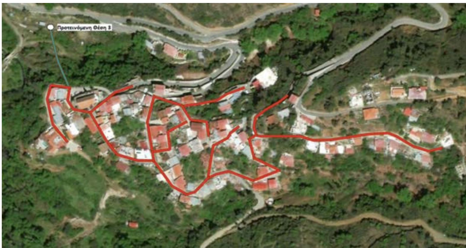
Εικόνα 169: Προτεινόμενο Αποχετευτικό Δίκτυο Οίκου – Εναλλακτική 3 η
