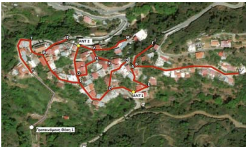
Εικόνα 163: Τμήμα Αποχετευτικού Δικτύου Οίκου
