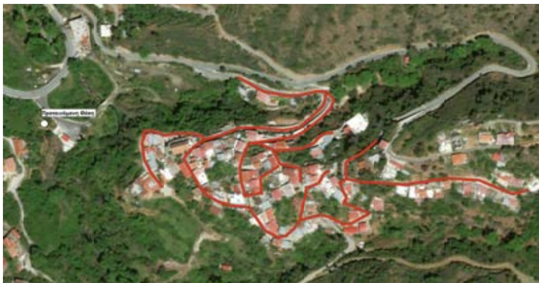
Εικόνα 192: Προτεινόμενο Αποχετευτικό Δίκτυο Οίκου
