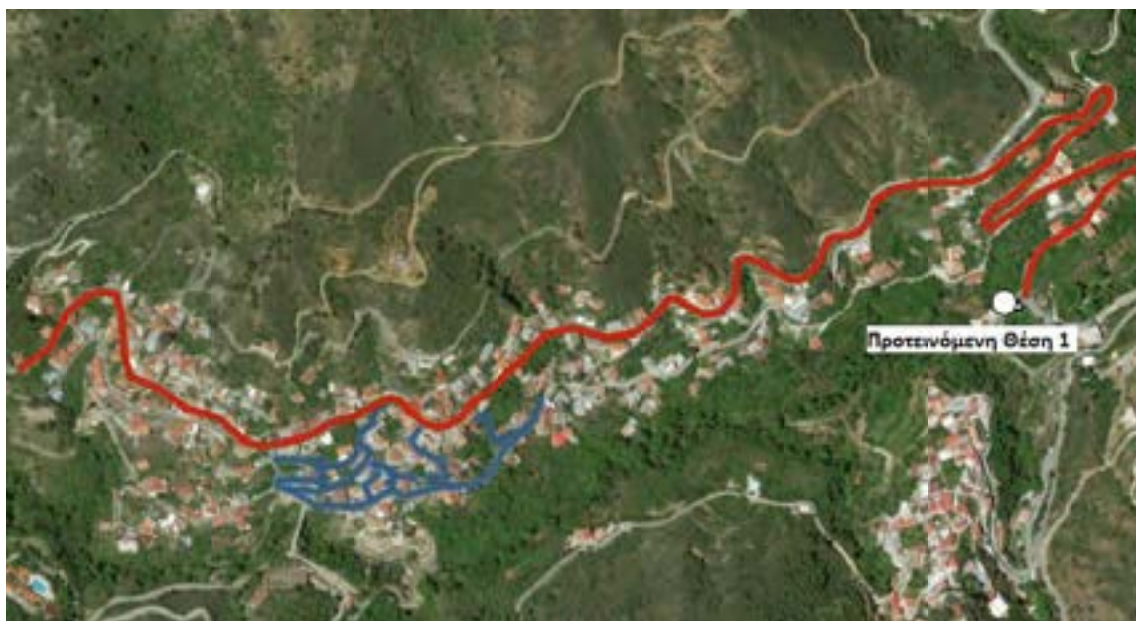
Εικόνα 178: Κεντρικό Αποχετευτικό Δίκτυο (κόκκινο) Καλοπαναγιώτη
