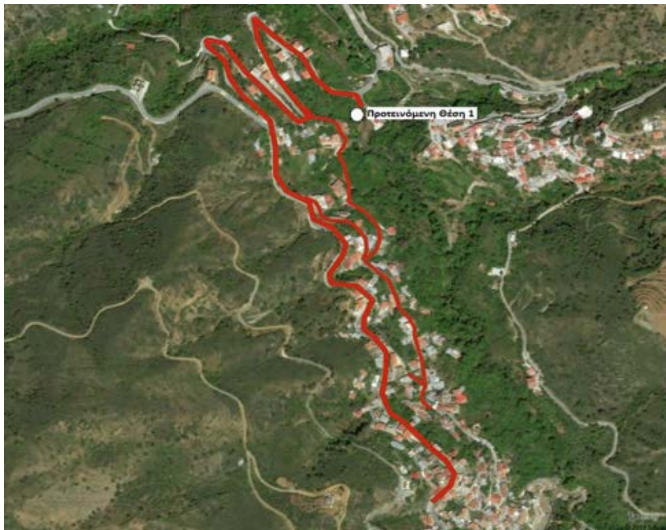
Εικόνα 186: Προτεινόμενο αποχετευτικό δίκτυο για μεταφορά λυμάτων στη θέση 1
