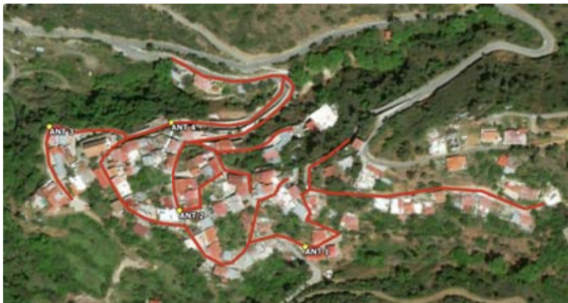
Εικόνα 193: Απαιτούμενες ανυψωτικές αντλίες αποχετευτικού δικτύου Οίκου
