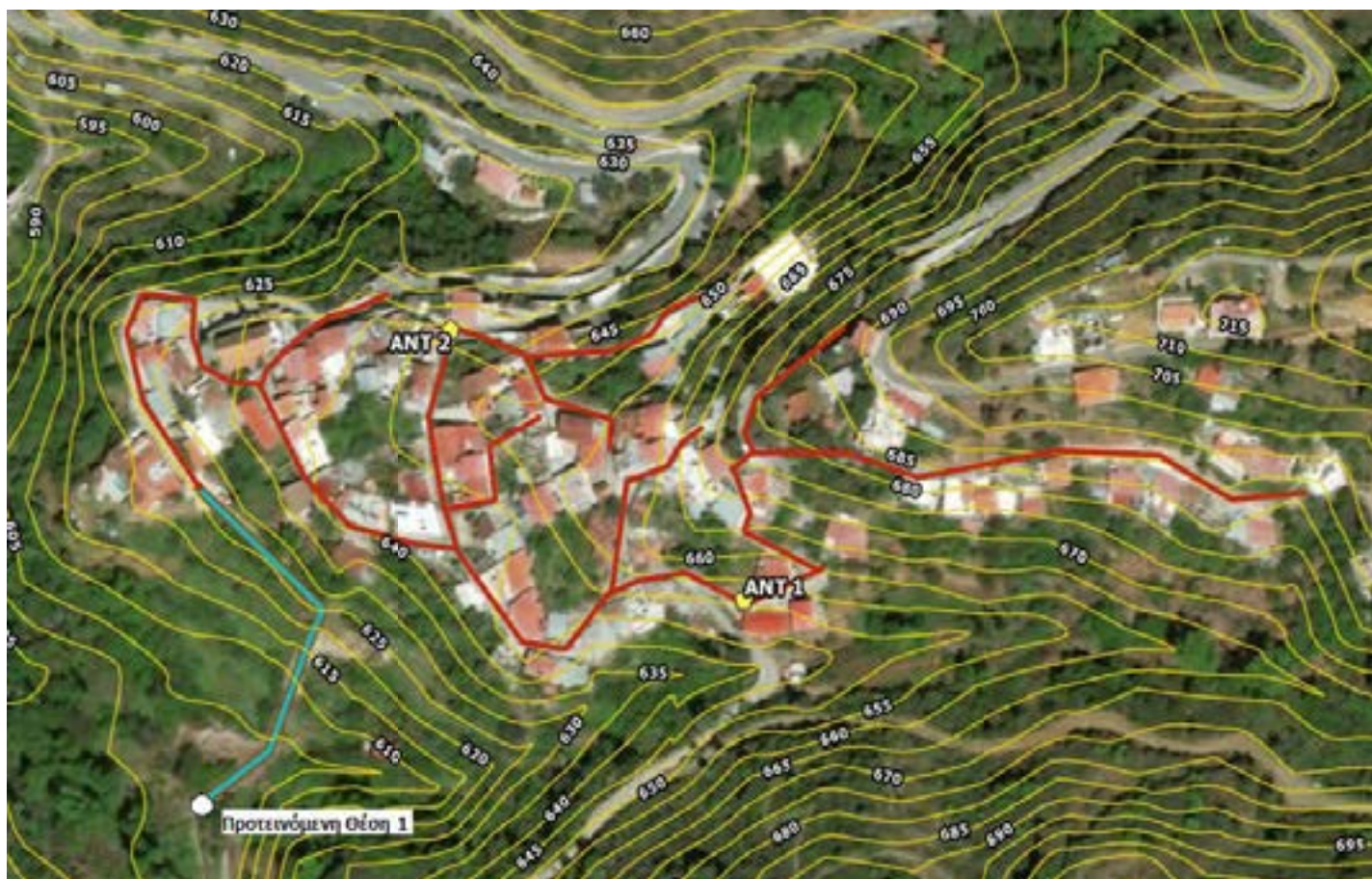
Εικόνα 164: Ελάχιστα απαιτούμενα αντλιοστάσια
