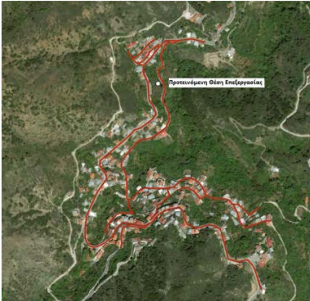
Εικόνα 152: Προτεινόμενο Αποχετευτικό Δίκτυο Μουτουλλά
