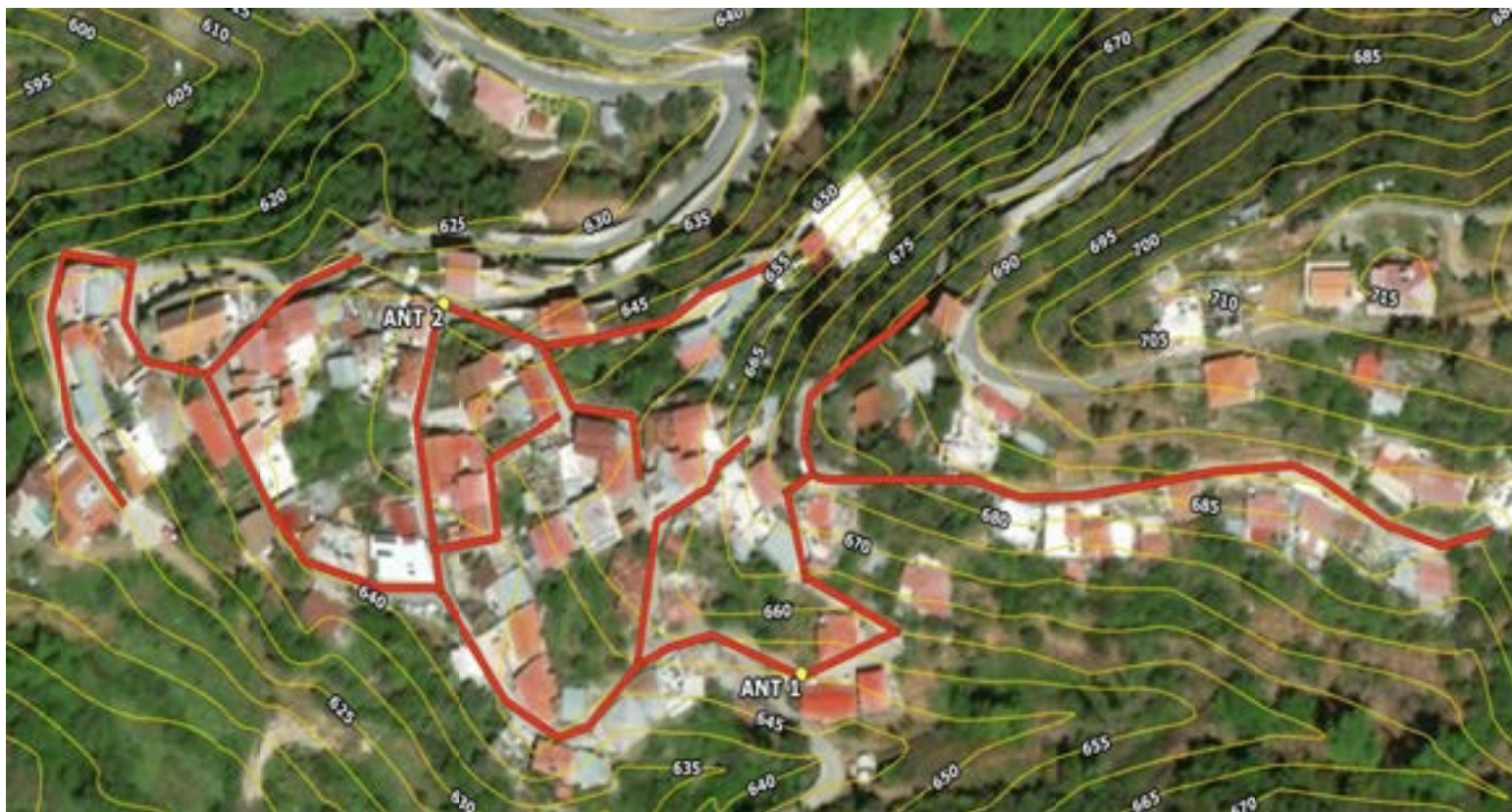
Εικόνα 172: Ελάχιστα απαιτούμενα αντλιοστάσια
