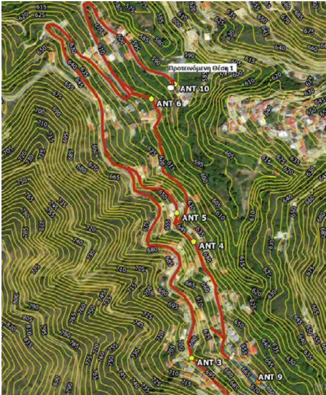
Εικόνα 182: Αντλιοστάσια ανύψωσης λυμάτων αποχετευτικού δικτύου Καλοπαναγιώτη (Μέρος 2 ο )
